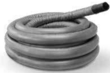
**Descrizione:** tubo flessibile ad alta resistenza ed alta flessibilità antistatico ed antibatterico per distribuzione aria in impianti VMC con isolamento esterno in polietilene espanso spessore 3,5 mm. Per altri dati tecnici e prestazionali vedi MVDNIFLEX.
