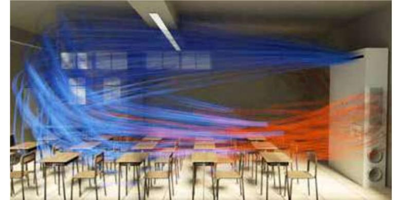
Simulazione fluidodinamica CFD mandata/ripresa VMCS600/VMCS1200 con installazione a soffitto.
