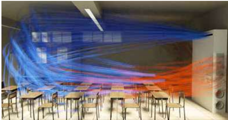
Simulación fluidodinámica CFD de salida / retorno VMCE600 + SBVMCE600 con instalación en la pared en el aula escolar. CFD fluid dynamics simulation supply/return VMCE600 + SBVMCE600 wall installation in a classroom.
