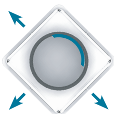
Con deflettore su di un lato della valvola per funzionamento in mandata (3 direzioni) With deflector on a side of the vent for a blowing mode (3 directions)
